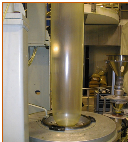
Vervaardiging van een multilaags bioplastic folie door middel van folieblazen (foto: Agrotechnology & Food Innovations, Wageningen)
